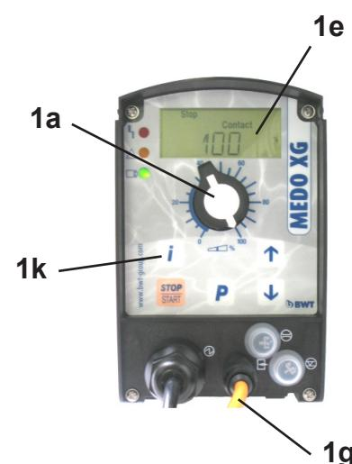
Le connecteur 5 broches (1g) permet différents modes de fonctionnement (voir paragraphe 10).
