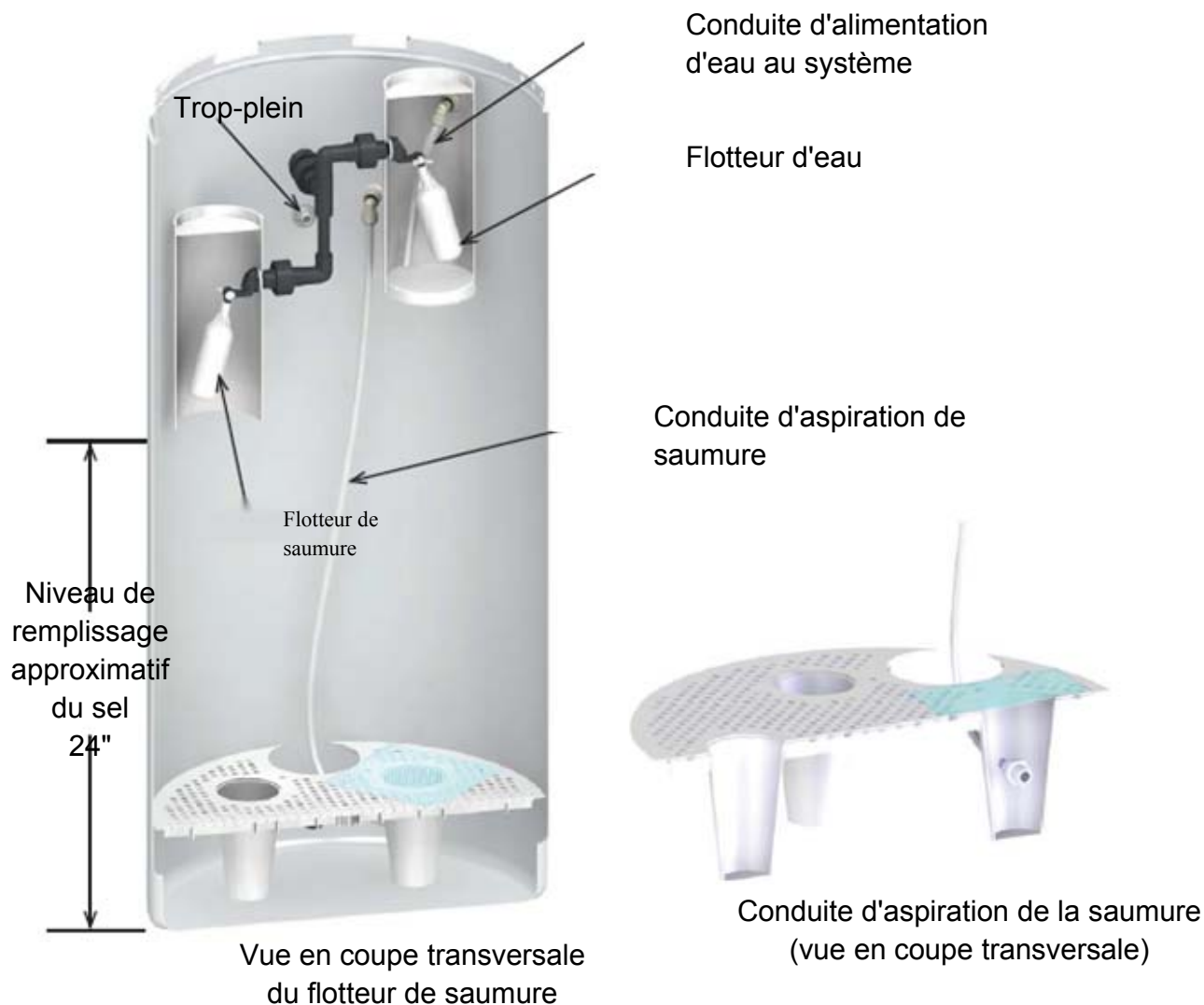
Figure AE 1-3. Composants internes du réservoir de saumure
