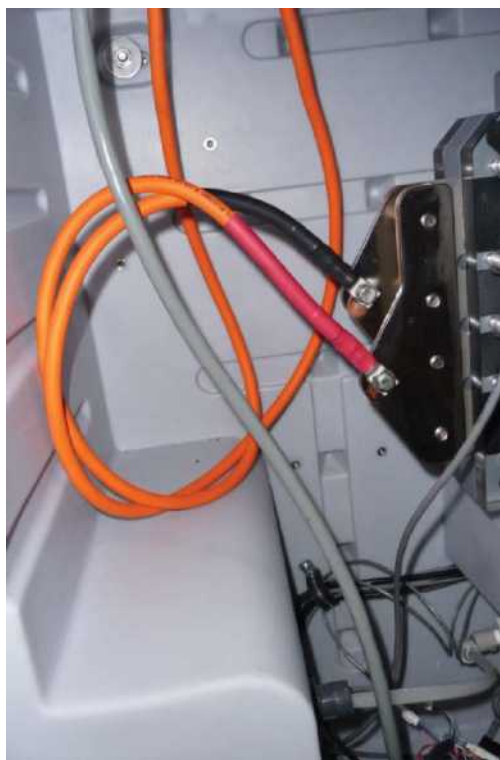
Figure 2-19. Connexion des fils de la cellule et des barres bus
