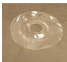
Figure 6-2. Disque de rupture défectueux
