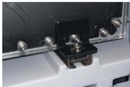
Figure 2-21. Équerre de support de la cellule
