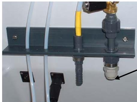
Positionnement du tubing pour l'alimentation en eau. Clips de verrouillage à mettre en place.
