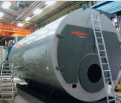
Montage de la jaquette d'isolation de la chaudière en usine
