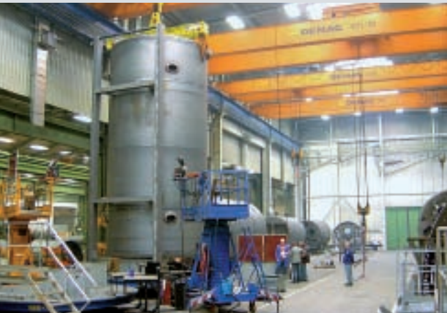
Soudage du corps sous pression en position optimale
