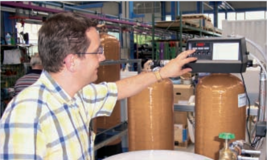
Fig. 49 : Paramétrage de l'équipement à échangeur d'ions
