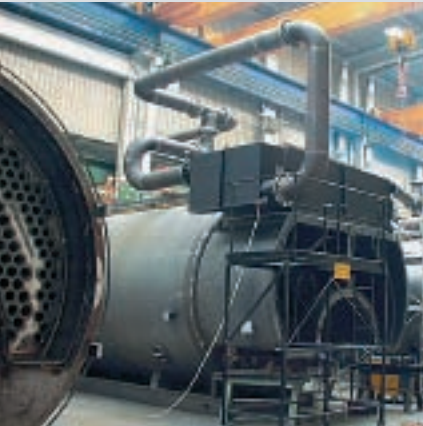
Fig. 93 : Vitomax 200 HS avec surchauffeur, 22 t/h à 10 bar pendant la fabrication, installée dans l'entreprise Klaipedos Kartons AB (fabrication de carton ondulé) à Klaipeda, Lituanie
