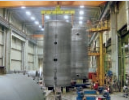
Soudage du corps sous pression en position optimale
