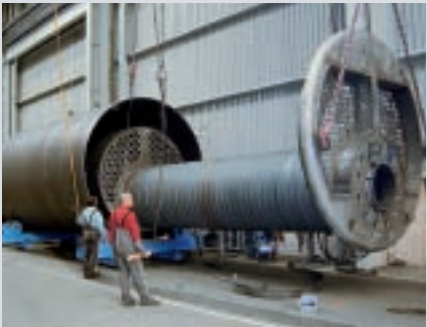
Assemblage de la virole de la chaudière et de la chambre de combustion cylindrique
