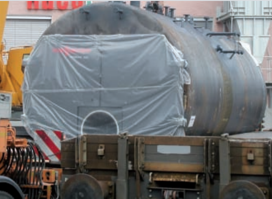
Fig. 79 : Transport sur rails sans isolation
