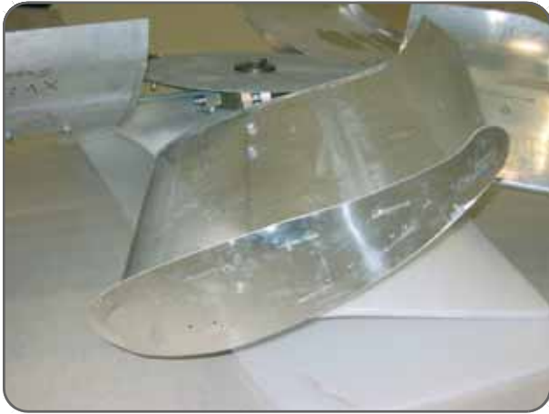
Conception unique des extrémités pour une atténuation acoustique accrue
