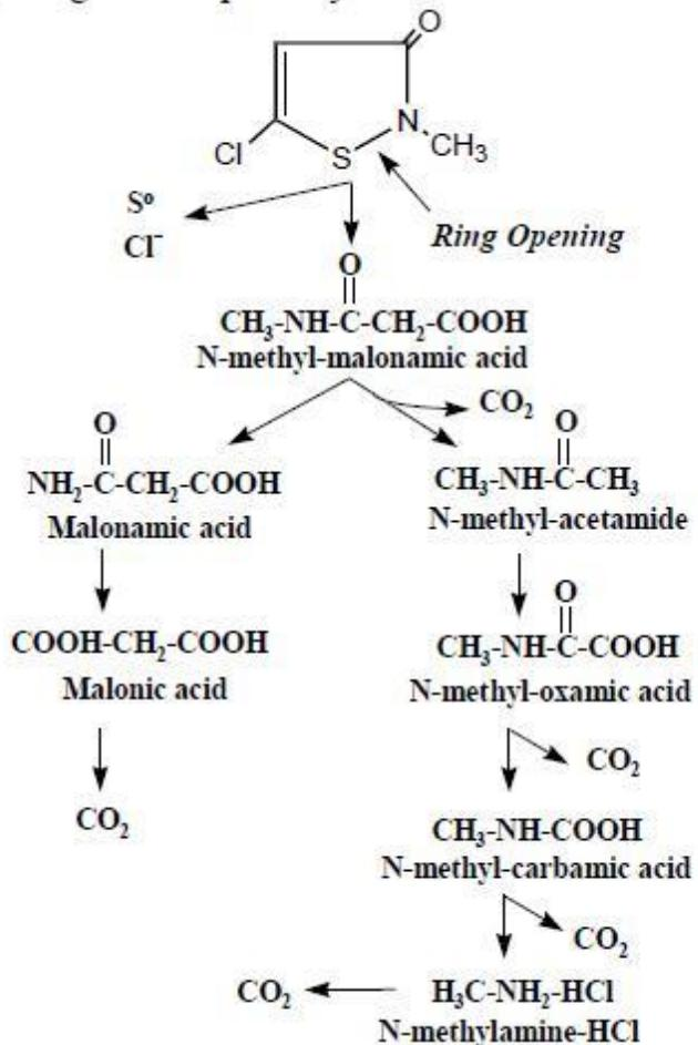
*L'apparition et la concentration de ces produits de décomposition ont pour origine la matière active intrinsèquement mais aussi les conditions spécifiques d'exploitation du circuit (temps de séjour, température,...) et les réactions avec les polluants présents dans l'eau. Il nous est donc impossible d'en prédire les concentrations a priori.*
