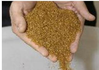
L'avantage de ce système est de pouvoir «recharger» facilement le produit en ions sodium lorsqu'il est saturé par les ions calcaires (Ca-Mg). On appelle cette opération la régénération des résines.
