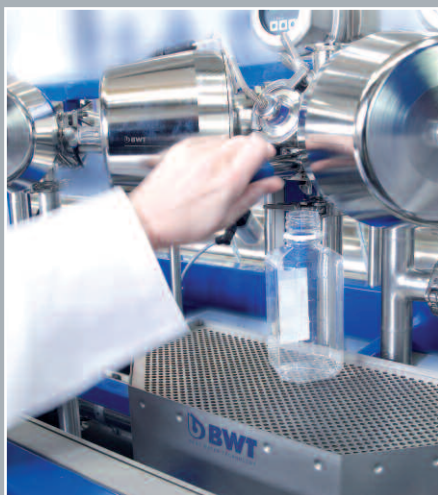
Prélèvement aisé d'échantillons de tous les points de mesure entrant en ligne de compte pour la qualité sur le tableau central.
