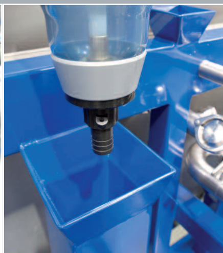
L'évacuation des eaux usées intégrée au châssis ERGOSKID confère à l'ensemble une bonne clarté et permet de réduire le nombre de tuyaux.
