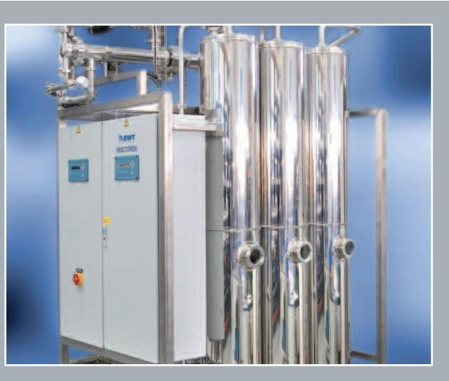
Nos systèmes de distillation MULTITRON répondent aux exigences des pharmacopées les plus utilisées telles que la pharmacopée Européenne et l'USP.
